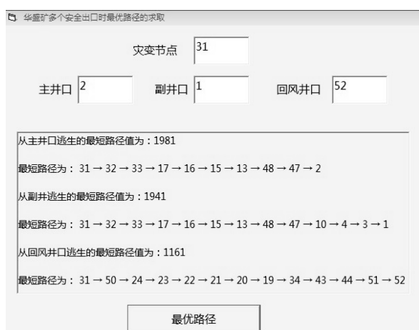
图6 华盛矿多个安全出口最优路径求取界面
