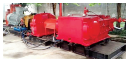
(b) 压裂泵组
